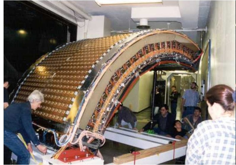
Komora dryfowa eksperymentu PHENIX na zderzaczu ciężkich jonów w Brookhaven National Laboratory (USA)
