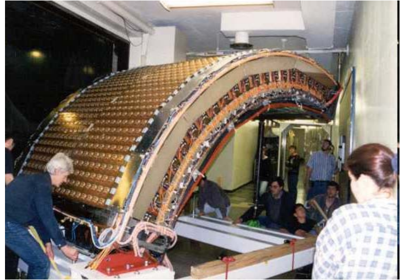
Komora dryfowa eksperymentu PHENIX na zderzacz ciężkich jonów w Brookhaven National Laboratory (USA)
