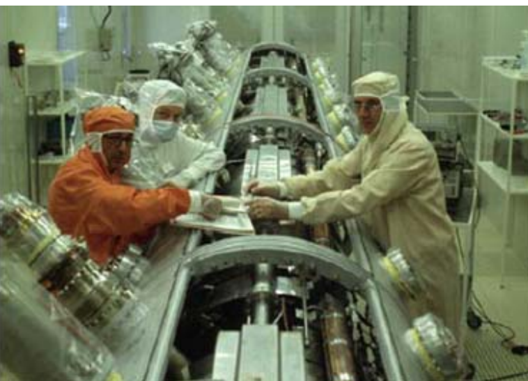
Prace w laboratorium BNL / USA przy przygotowywaniu materiału do budowy wnęk rezonansowych.
