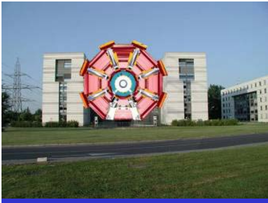
ATLAS w porównaniu do 5-cio piętrowego budynku
