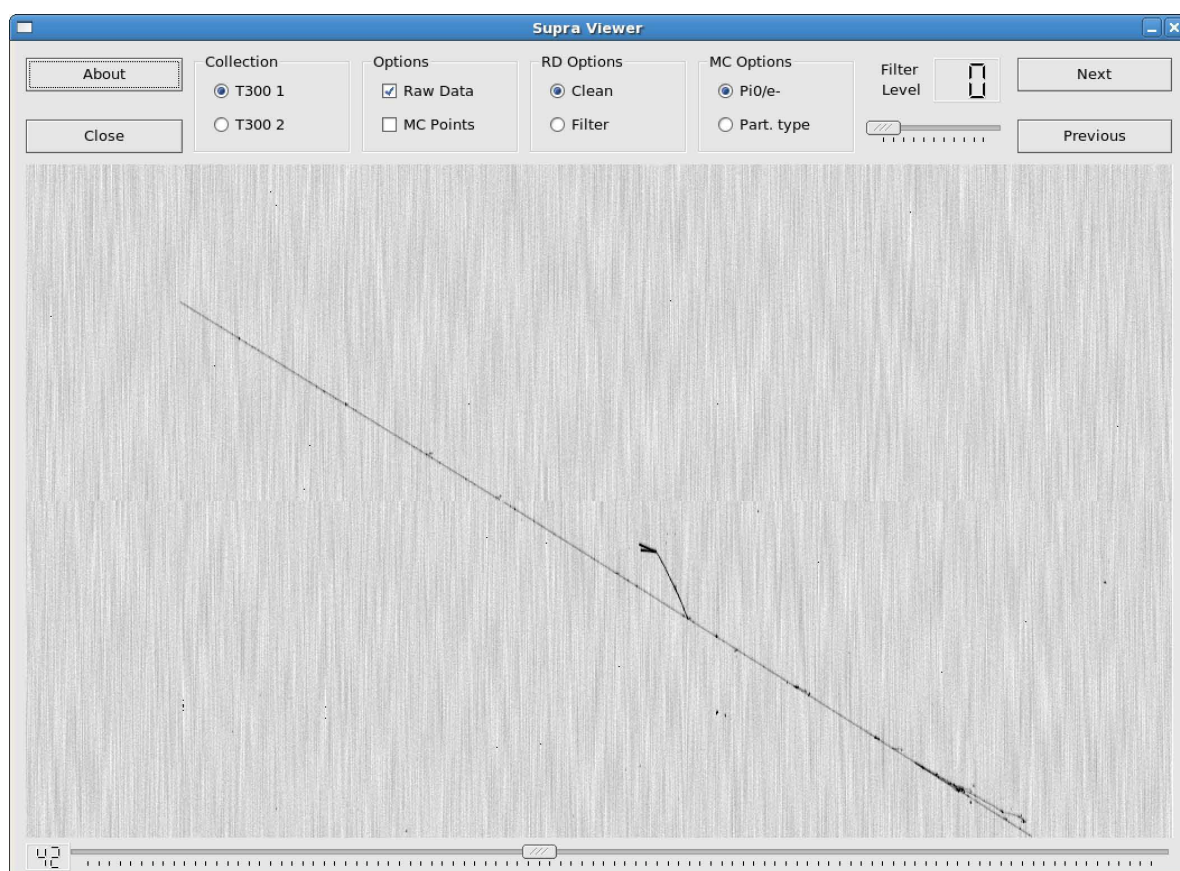
Rysunek 4.13: Okno Supra Viewer - dodatku do QSCANA. Na rysunku widoczny tor mionu o energii 1 TeV, przechodzący przez obie komory TPC modułu T300.
